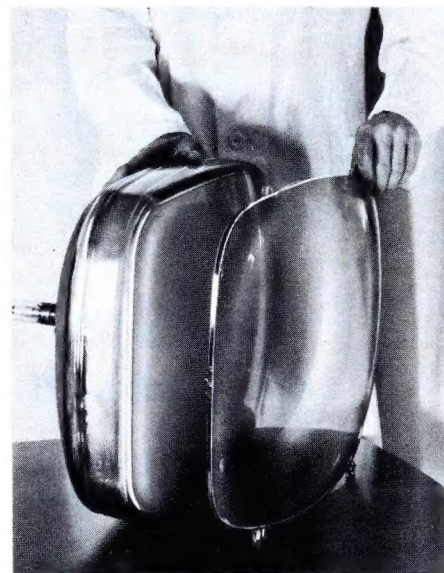
Bild 3. 110°-Bildröhre und Kunststoff-Schutzscheibe
