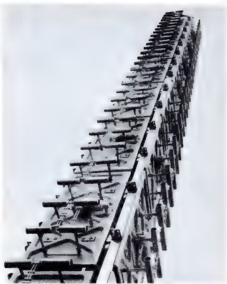
Bild 2. Die unverkleidete Antennenanlage; man erkennt je vier Dipole auf einer profilierten Tragplatte
